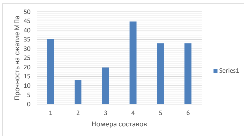
Рисунок 4. Прочность на сжатие образцов мелкозернистого бетона 1 состав – 5% микронаполнителя в образце; 2 состав – 10% ; 3 состав – 15% ; 4 состав – 20% ; 5 состав – 40% ; 6 состав – контрольный без микронаполнителя
